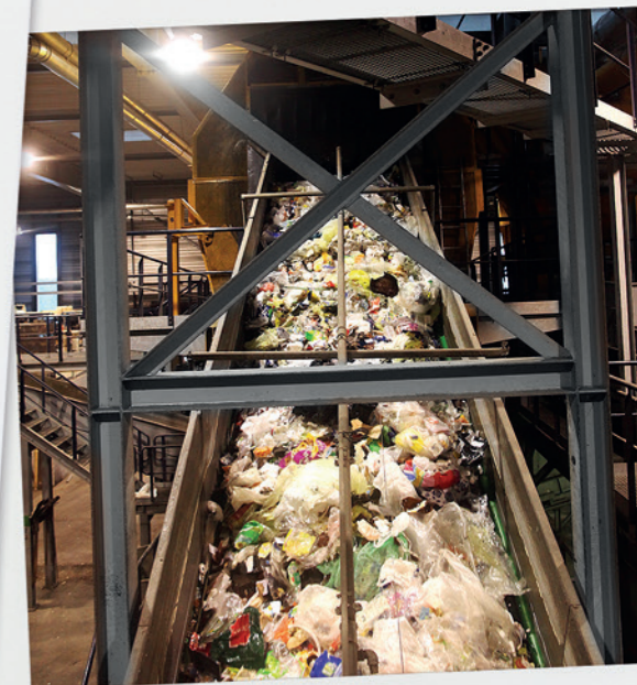
In Jogginggeschwindigkeit rennt mein Becher die Bänder entlang. Verschiedene Sortierverfahren trennen das Material in vier Kunststoffsorten.
