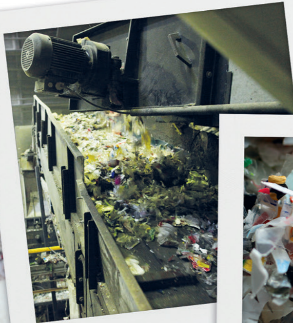
Hier wird der Becher mitsamt dem anderen Polypropylen-Material erneut gereinigt und getrennt.
