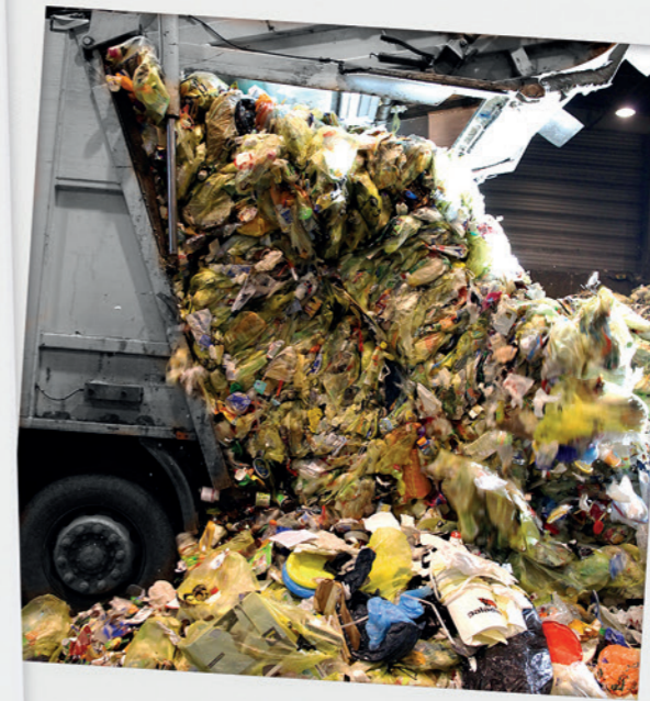
Die Säcke werden abgekippt und mit großem Getöse von einem Bagger auf Förderbänder geschaufelt.
