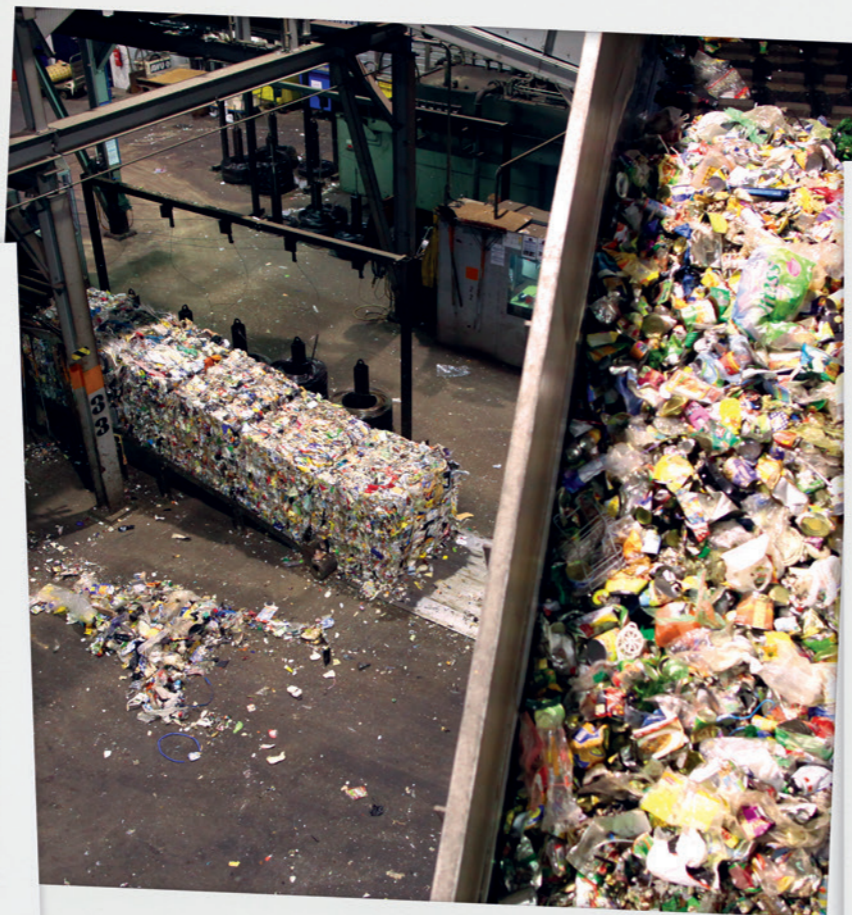
Die zu 98 Prozent sortenreinen Kunststoffe fallen in den „Bunker“ und werden zu Ballen gepresst.
