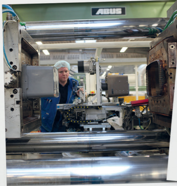
Dazu wird das Granulat wieder geschmolzen und auf eine Matrize geschossen.
