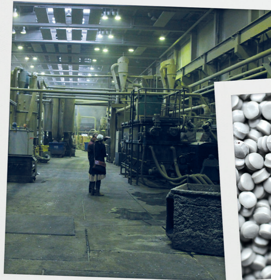
In einer der Maschinen werden die Flakes meines Bechers aufgeschmolzen und durch ein Siebfilter herausgedrückt.
